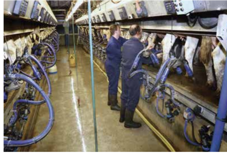
Evert melkt stevast samen met een medewerker. De koeien worden gemolken in een 2 x 20-stands zij-aan-zij rapid exit melkstal van DeLaval, met daarin driehoekige tepelvoeringen met koppeluchting van Milkrite.
